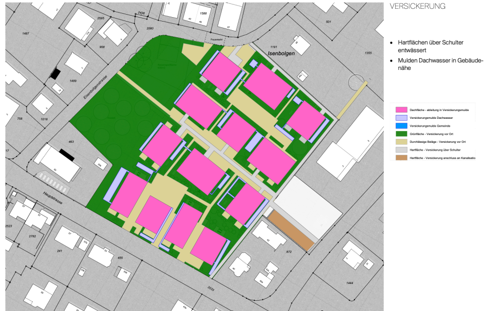
Abb. 6: Schema «Versickerung», Richtprojekt «Zumbrunnmatte», Stand 02.02.2026 [Reimann Sidler Architekten/extrā Landschaftsarchitekten AG]
